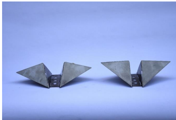
Bild 5: links: Reflektor um 23° gebogen; rechts: Reflektor um 45° gebogen
