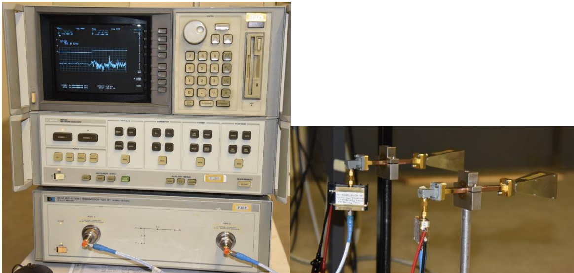
Bild 3: Messeinrichtung, links: VNA, rechts: Sende- (links) und Empfangs- (rechts) Antenne.
