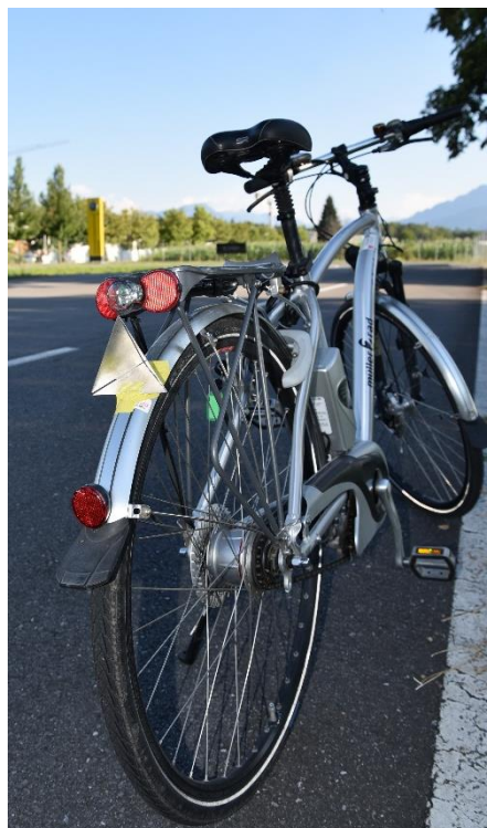
Bild 9: Montage des Radarreflektors am Schutzblech des Velos
