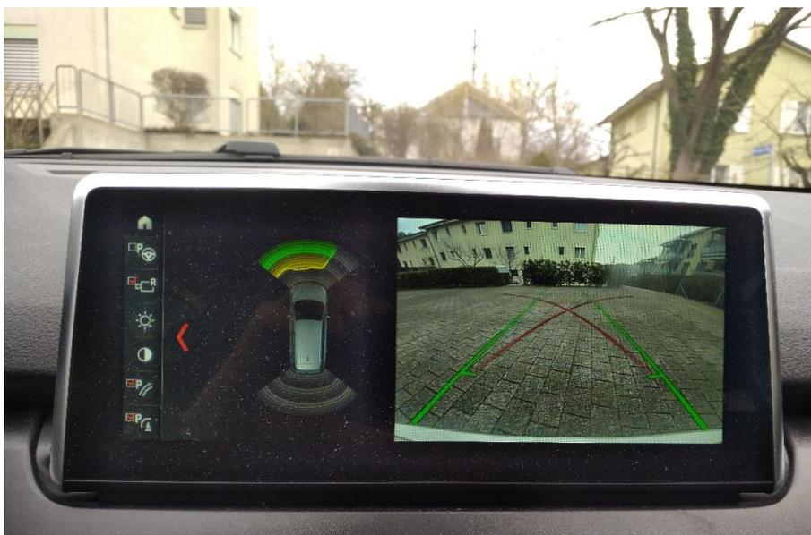
Abbildung 3: Bildschirm in einem BMW-Serie 2: Ultraschallsensoren (links), Rückfahrkamera mit überlagert Information des aktuellem (grün) und maximalem Kurvenradius (rot) (rechts).
